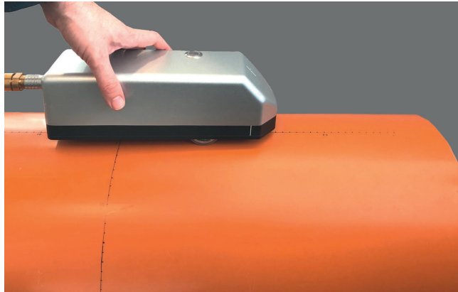
Bild 2. Messaufbau mit Terahertz-FMCW-Handscanner: Messungen im Feld, z.B. an Fernwärmerohren, sind mit dem mobilen Terahertz-Sensor möglich (© Fraunhofer ITWM)
